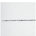
Cotation inclusionnaire dans l'acier selon la norme DIN 50602
